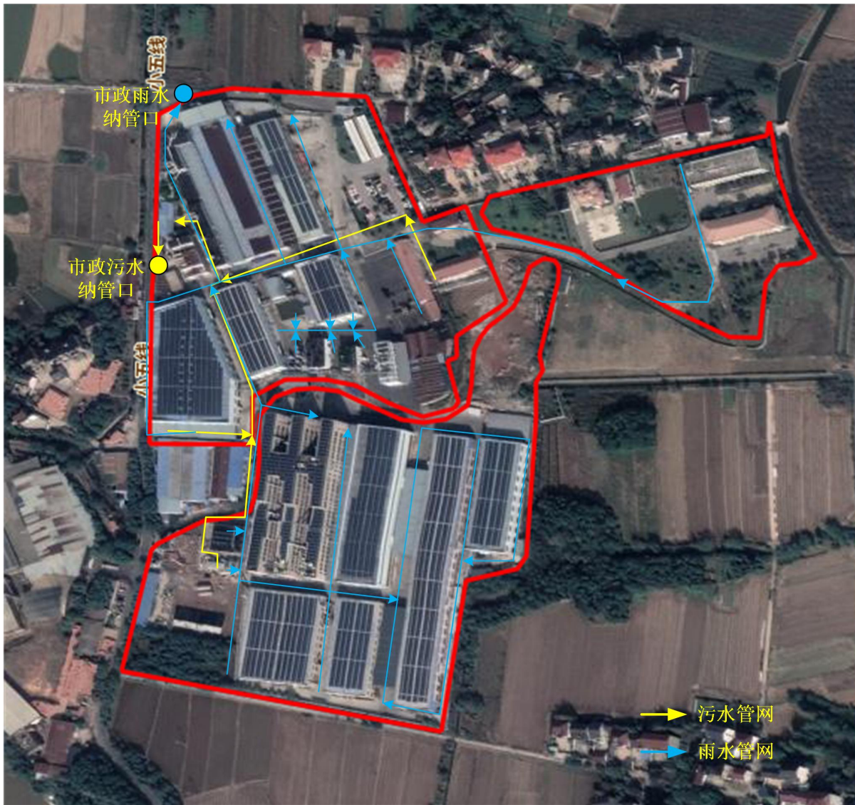
图 4.5-2 企业现状厂区雨污管网图
